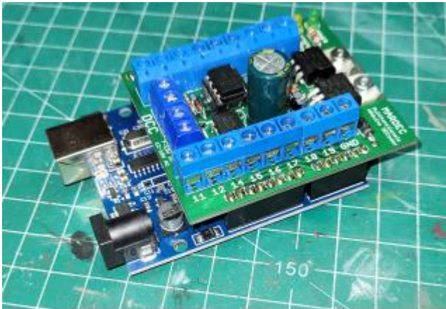
Arduino met opzetprintje (shield) om de ledjes aan te sturen.
