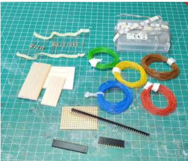
Leds (intratuin kerstmarkt) weerstanden, decoderdraad, pinstrips en balsahout voor de plafonds
