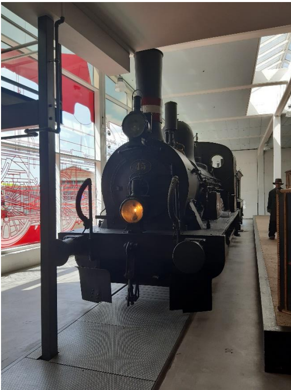
De stoomlocomotief B45 gebouwd door Robert Stephenson & Co in 1869. Deze heeft dienst gedaan van 1869 tot 1924. Hij reed door heel Denemarken, snelheid 90 km/pu. De eerste lijn waar deze locomotief reed was het traject Kopenhagen-Roskilde. Er zijn 11 exemplaren geleverd. Op de omslag van jaargang 35 nummer 2 staat dezelfde locomotief afgebeeld.
